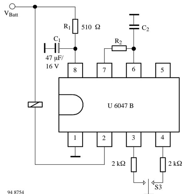
Figure 4b ON/OFF function U 6047 B
